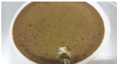
Huidig stadium van struvietraffinage, struvierijke neerslag
