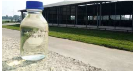
Ammoniumnitraat teruggewonnen uit het stripping-scrubbing proces
